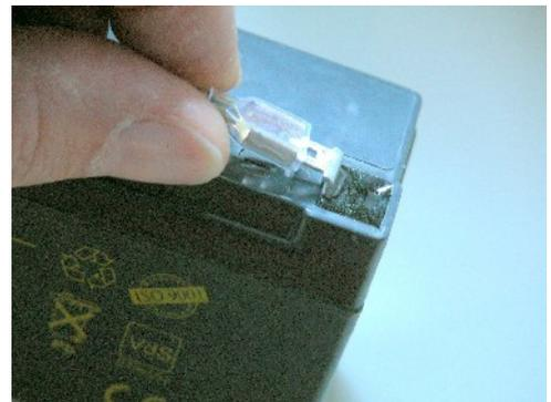
4. Stecken danach den Stecker für die Spannungsversorgung in die entsprechende Buchse des Senders.
