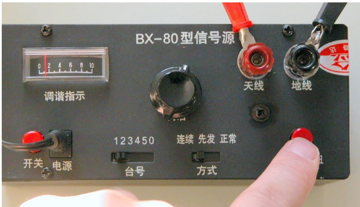
7. Justieren Sie den Abstimmknopf des Senders auf den größtmöglichen Ausschlag des Messinstruments. Fassen Sie beim Betrieb des Senders nicht das Metallgehäuse an. Erstens verstimmt es den Sender, und zweitens kann man sich dabei an der HF verbrennen ;-)
